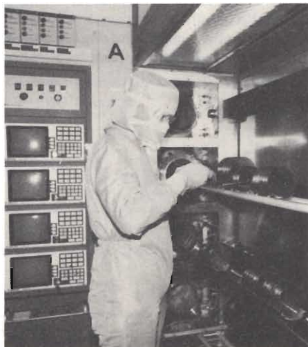
Caricamento dei wafer in un forno controllato mediante computer.
