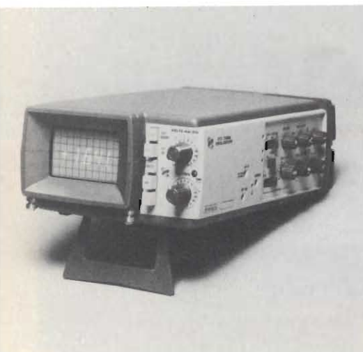
Fig. 4b - Oscilloscopio TEKTRONIX 213 funzionante come multimetro.
