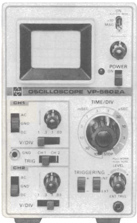
Fig. 17 - Oscilloscopio a batteria V1-5602 A NATIONAL.
