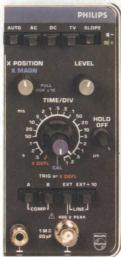
Fig. 12 - Particolare del pannello con base dei tempi doppia (principale e ritardata) dell'oscilloscopio PHILIPS PM 3217B.
