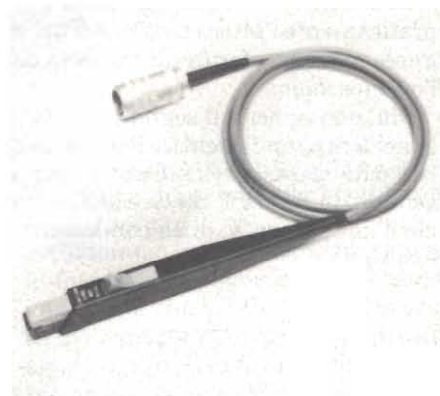
Sonda per la misura delle correnti. Elimina la necessità di calcolare il valore della corrente attraverso la caduta di tensione ai capi di un resistore campione. Queste sonde possono essere a trasformatore (solo correnti alternate) o ad effetto di Hall. Le prime hanno una risposta fino a 100 MHz, le seconde fino a 50 MHz. (Foto Tektronix).
