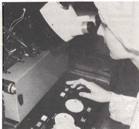
Sistema di collegamento veloce dei terminali (bonding).
