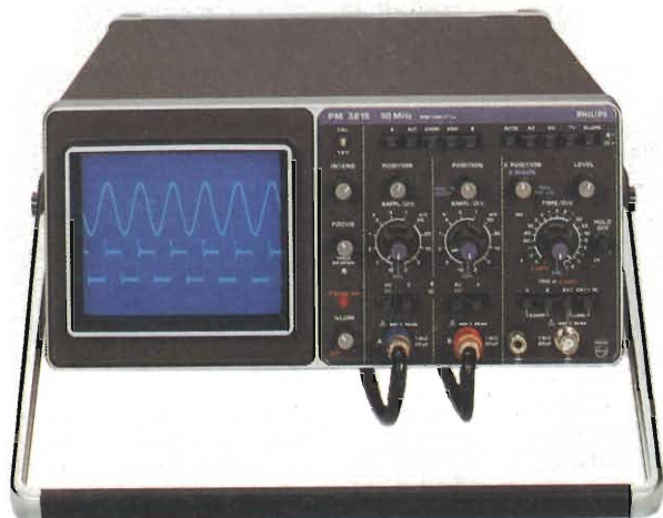
Fig. 10b - Oscilloscopio PHILIPS PM 3217B a doppia traccia con doppia base dei tempi (principale e ritardata).
