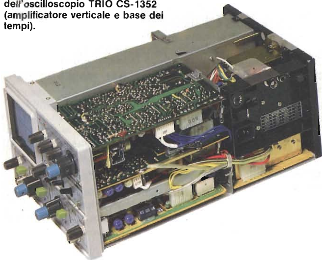
Fig. 14b - Vista interna dell'oscilloscopio TRIO CS-1352 (tubo CRT e sezione alimentazione).
