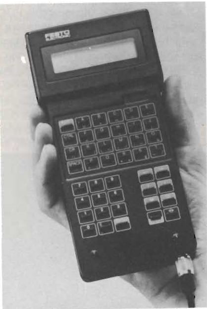
Unità portatile Mod.60A che programma e controlla chips logici in meno di due secondi
